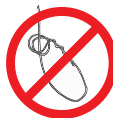
Figure 2 – Double nœud coulant traditionnel interdit
